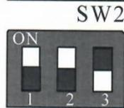
4. Chequeo por baja carga (dipswitch 3 en ON)
