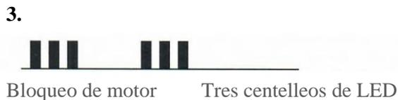
Posible solución: revisar si algún objeto se encuentra produciendo una traba mecánica en el motor o en la máquina.
