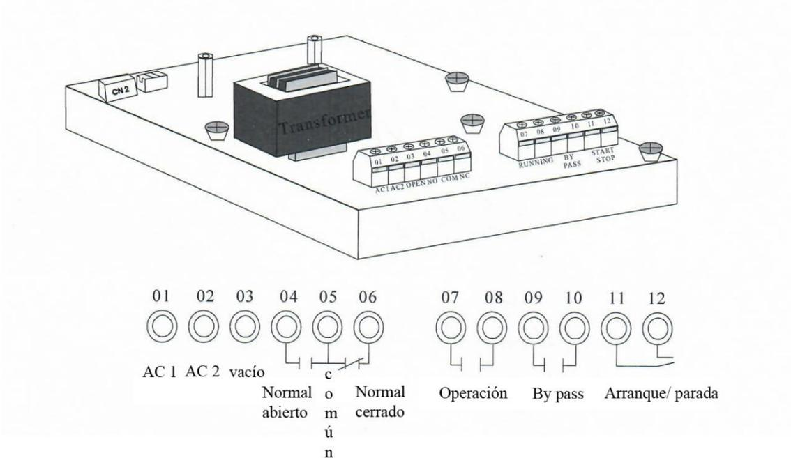
01-02. AC1- AC2: se conecta la alimentación auxiliar de 220Vca.
