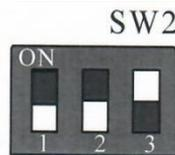
3. Arranque contra el límite de corriente con impulso de arranque (dipswitch 1 y 2 en ON)
